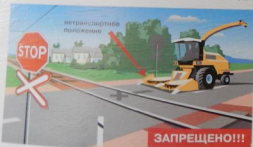
Запрещается движение через железнодорожные пути в метранспортном положении сельскохозяйственных тракторов, дорожных, строительных и других машин и механизмов (ст. 15.3 ПДД).
